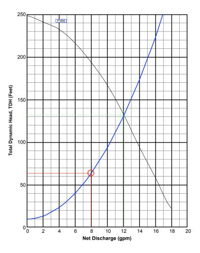
PumpData P1005 HH Effluent Pump Data P1005 High Head Effluent Pump 10 GPM 1/2HP 115V 1Ø Legend
